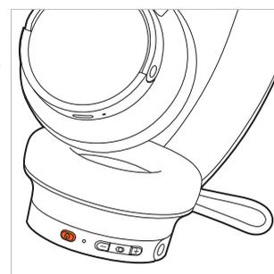
Bezdrátová sluchátka AVENTHO 100 lze s audio kabelem používat jak v zapnutém, tak ve vypnutém stavu.
